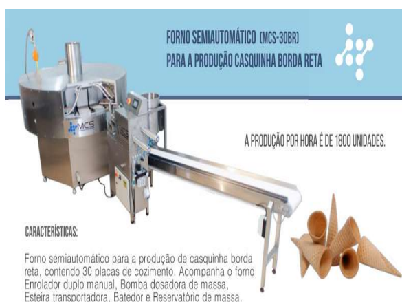
Figura 1. Equipamento para produção de casquinha para sorvete.
